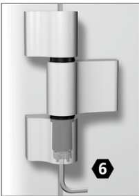
Mit Verstellstern untere Lagerbuchse um \pm 90^\circ drehen bis sie spürbar einrastet.
